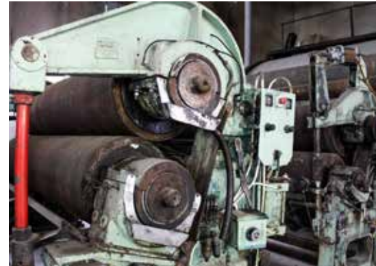
Pressene i oppfangermaskinen i tresliperiet. Foto: Kistefos.
