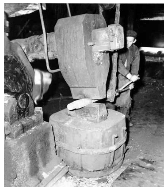
Den gamle vasshjulsdrivne hammeren var i drift inntil 1959. Foto: Næs Jernverksmuseum.
